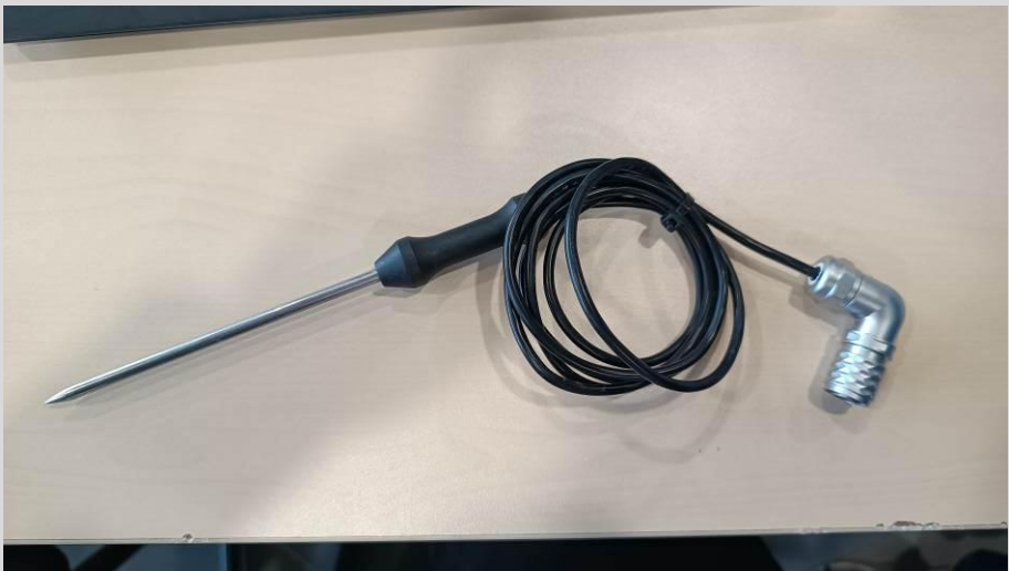
20 盘万能蒸烤箱（推入式）中心肉针探头
