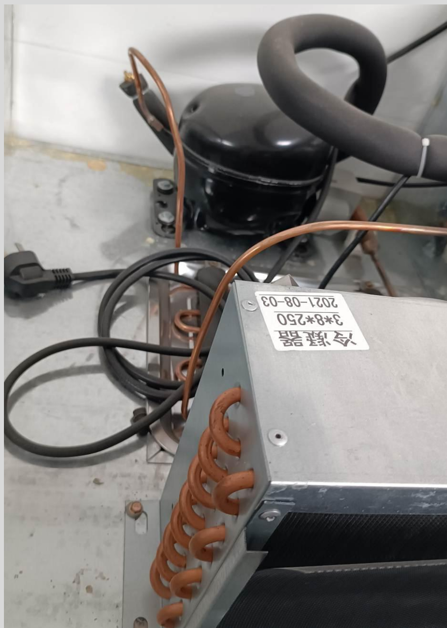
四门高身风冷雪柜（冷藏）压缩机、冷凝器
