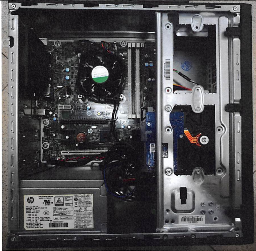
台式电脑主机内部结构
