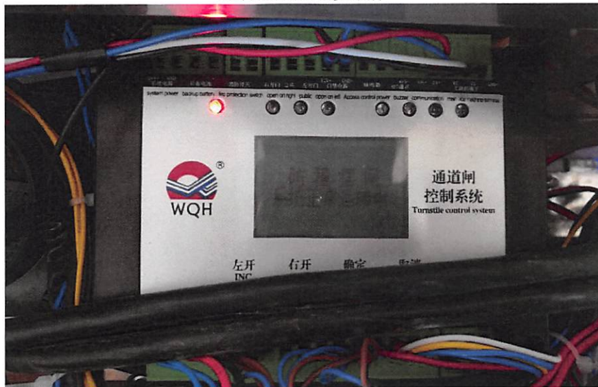
混合型双通道机控制系统
