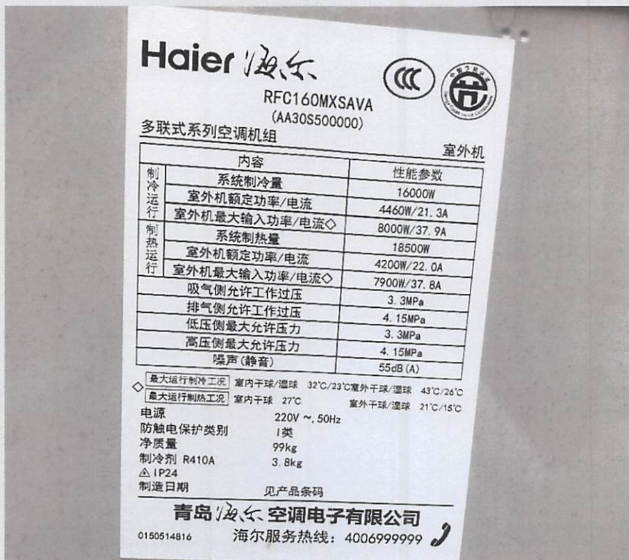
家用多联机壁挂式 (RFC160MXSAVA) 铭牌
